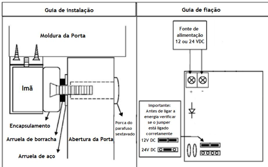
Para selecionar a alimentação, conectar a fiação e também para retirar a placa de suporte auxiliar (não utilizada na maioria dos casos), é necessário retirar a tampa desta área. Isto pode ser feito retirando o parafuso com uma chave Philips e puxando a tampa para o lado de fora.
