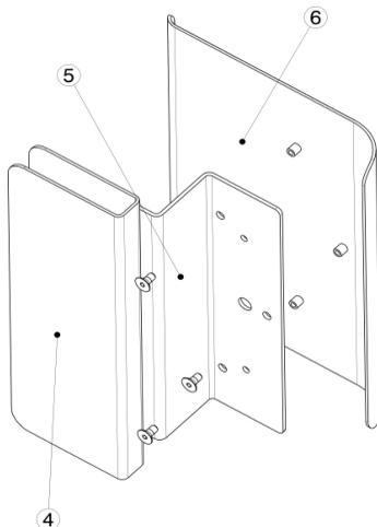
Depois de concluídos os passos anteriores para a montagem, conforme ilustra a figura ao lado. Fixe o Eletroímã a peça, utilizando um parafuso do tipo 2 e uma arruela para auxílio da fixação (A diferenciação dos parafusos consta na *Lista de Componentes*).
