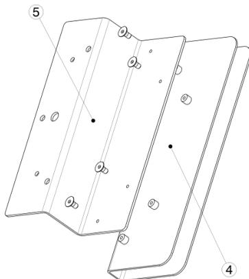
Após fixação das peças 4 e 5, utilize 3 parafusos do tipo 1 para fixar o Puxador (6) ao restante da peça.
