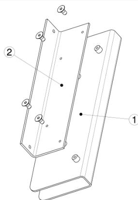
Após fixação das peças 1 e 2, fixe o eletroímã no suporte (2) com dois parafusos sem cabeça.
